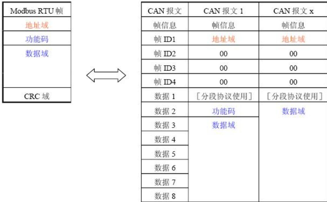
图 4.10 通信帧相互转换格式 (Modbus 方式)
