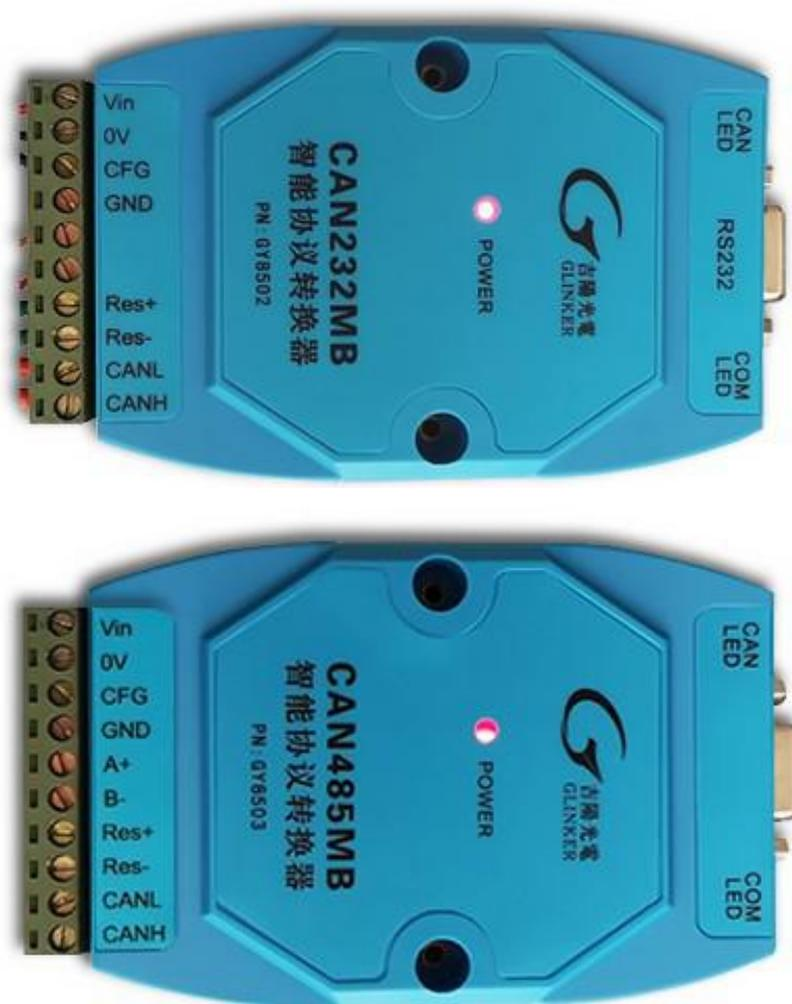
CAN232MB/CAN485MB 转换器具有两路用户接口。一路是CAN-bus接口，一路是RS232/RS485串行接口。其接口引脚定义如下。
