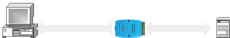
计算机-----CAN232MB/CAN485MB-----CAN设备
