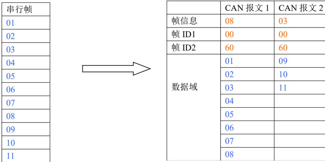
图 4.3 串行帧转CAN 报文示例（透明方式）
