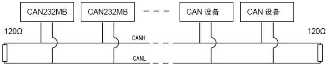
图 2.5 CAN 总线设备连接示意图
