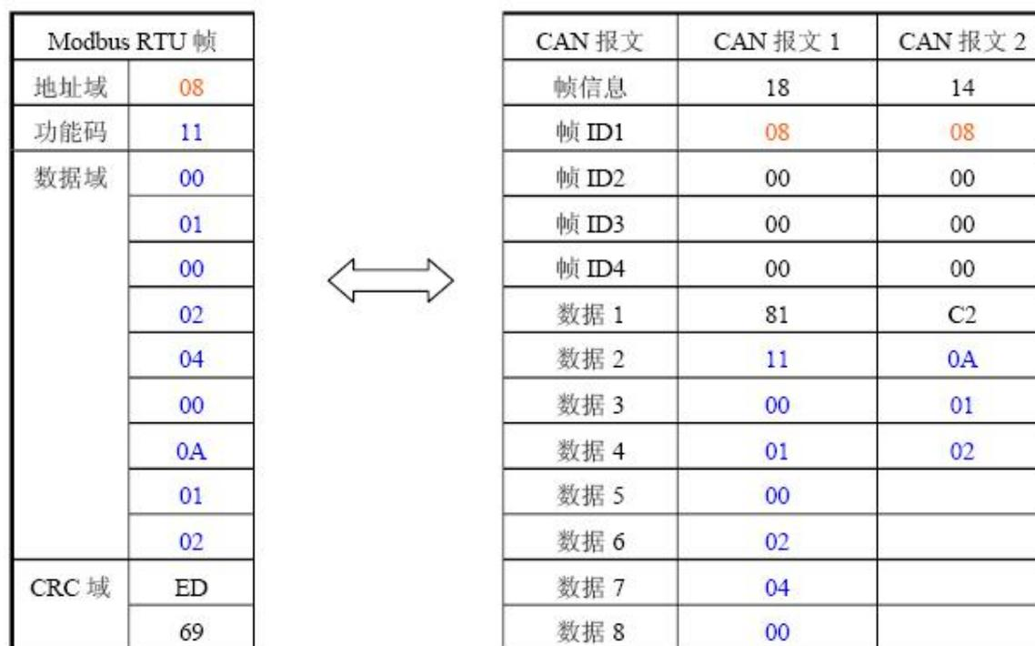
图 4.11 通信帧相互转换格式示例 (Modbus 方式)
