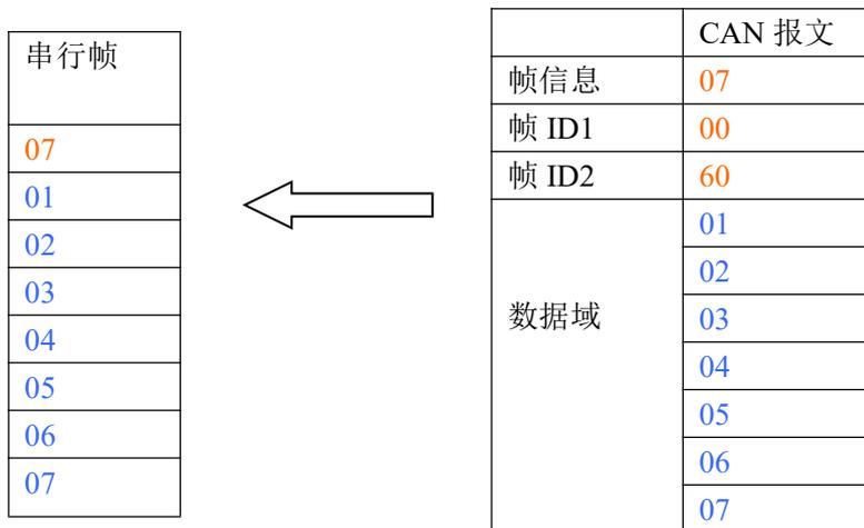
图 4.4 CAN 报文转串行帧示例（透明方式）
